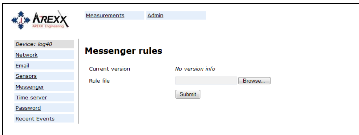
Abbildung 6: Auf dieser Seite des BS1000-Webserver können Sie die Messenger-Rule-Datei mit den Messenger-Regeln für die eingehenden Messdaten übertragen.
